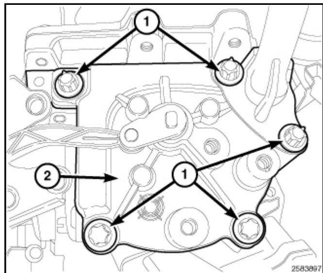
4. 固定EGR冷却器旁通真空鼓膜 (3). 紧固螺栓(2)至 12 N·m(106 in. lbs.)。
